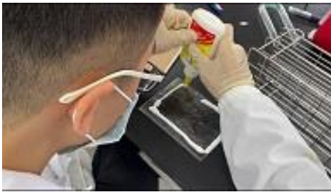
▲ 圖(三)在玻璃版四周擠上白膠，形成一個盆狀區域
